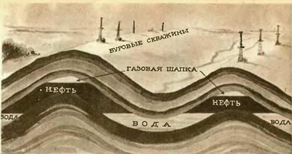
Антиклинальная структура. Слева и справа — две выпуклые складки. Это — антиклинальные складки, или, попросту, антиклинали. Посредине — вогнутая складка. Это — синклинальная складка, или синклиналь. В пласте находится нефть, газ и вода. В самой верхней части пласта — газ. Это так называемая газовая шапка. Под ней в пласте находится нефть. Еще ниже в пласте, по краям его — на крыльях — располагается вода. Скважины бурят на своде складки, чтобы они проникли в часть пласта, заполненную нефтью.
